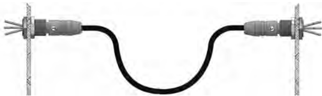
Kabelschleife Cable loop
