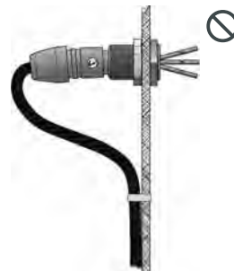
Entlastungsschleife – falsch Incorrect stress loop
